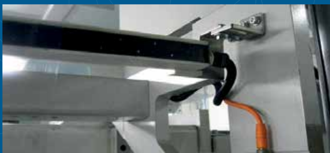
Barra antistatica BB londual 24V componente dell'ESA 24V
