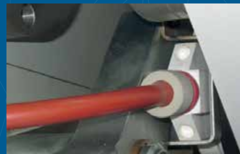
ACE DC60 - sistema ESA "carica diretta" che richiede isolamento del pressore
