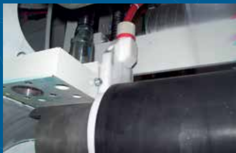
ACE DC50 - sistema ESA "carica diretta" che non richiede isolamento del pressore
