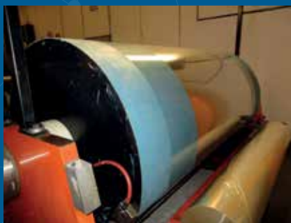
Tipica tiraprove rotocalco con sistema ESA ACE
