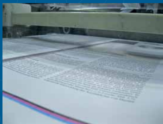
Nastri di carta in passaggio attraverso il gruppo Ribbon Charging
