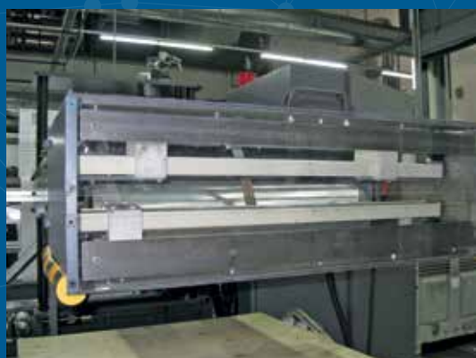
Ribbon Charging in applicazione orizzontale per macchine da bobina digitali.
